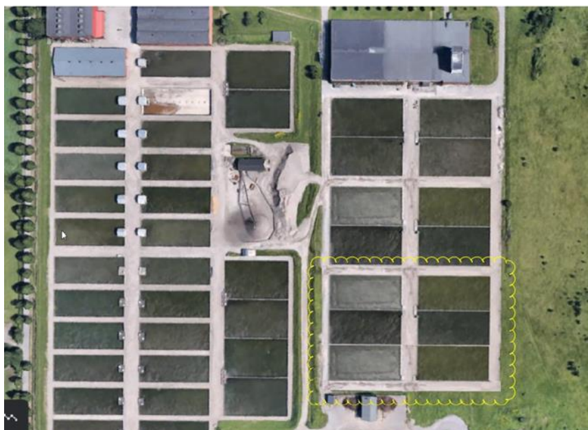
Bild 1. Flygfoto över Norsborgs Vattenverk, höger i bild visas ett bildmontage över den tänkta placeringen av sex stycken nya långsamfilter på östra verket.
